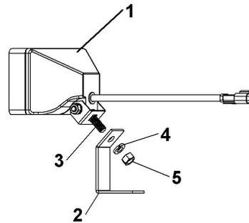
Percer un trou avec une mèche 11/32" à l'endroit approprié pour installer la lumière.
