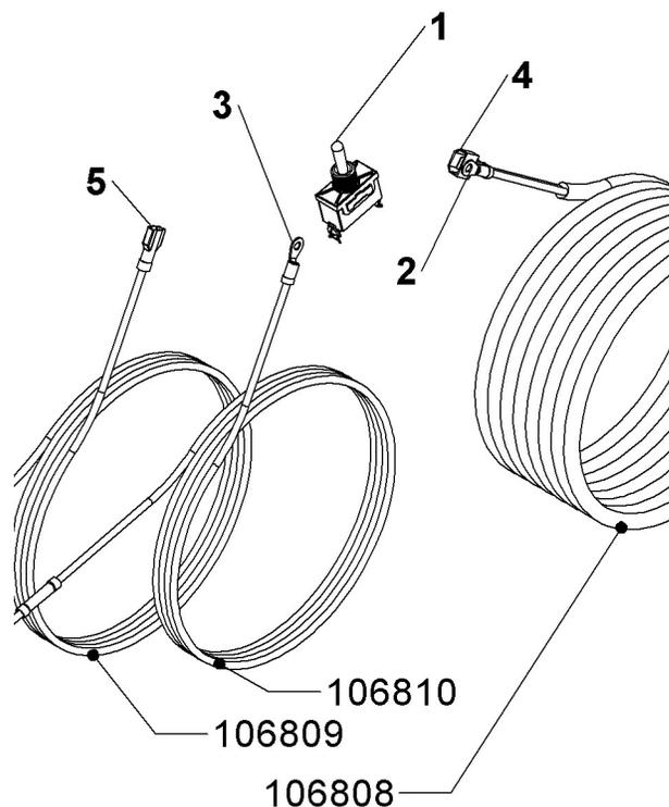
Percer un trou  $\varnothing 1/2''$  à l'endroit approprié dans le tableau de bord. Positionner le commutateur (item 1) dans le trou et le sécuriser en place à l'aide du capuchon (item 2)
