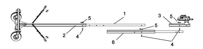
Cette extension pour sous-châssis universel permet d'installer l'accessoire sur des véhicules plus long. L'option intégrée au sous-châssis original d'ajouter 33 po. au sous-châssis.
