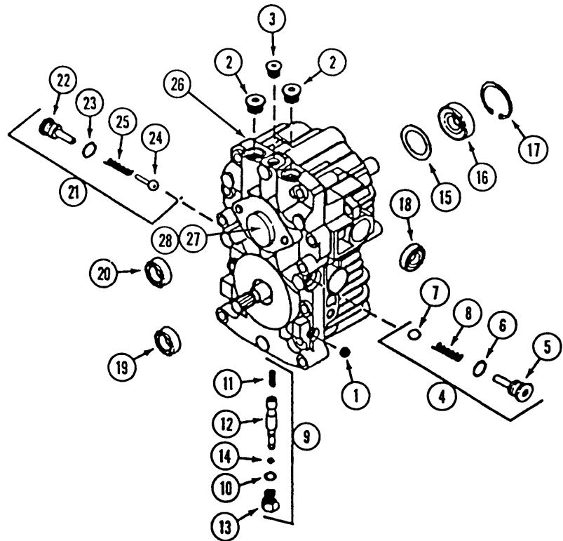
**INDEX****HYDROSTATIC PUMP-ZT DRIVE**
